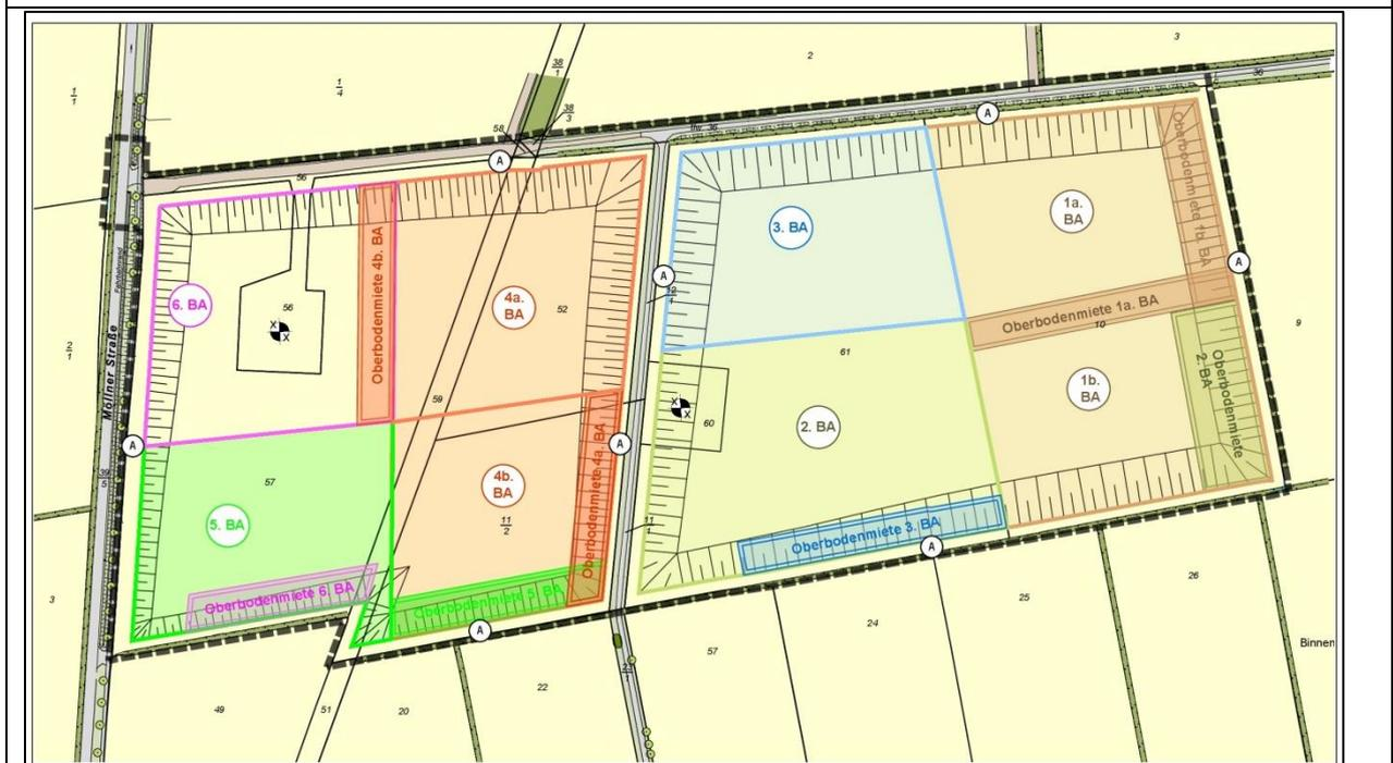
Abbildung 3: Schematische Darstellung der Abbauschritte bzw. Bauabschnitte. Quelle: BWW, Stand 11.10.2017
